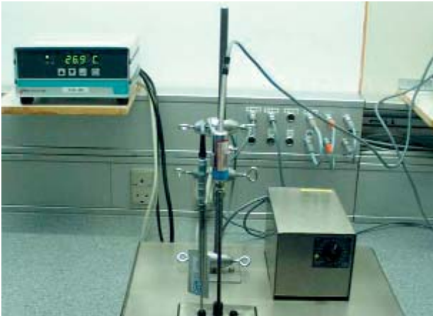
Klassische Variante der Kalibrierung: Badthermostat mit einem SPRT einschließlich Anzeigegerät.
