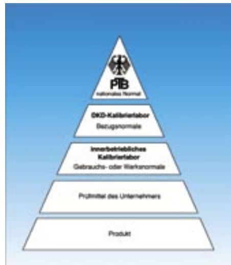
Bild 2: Kalibrierhierarchie vom nationalen Normal bis zum Produkt [7]
